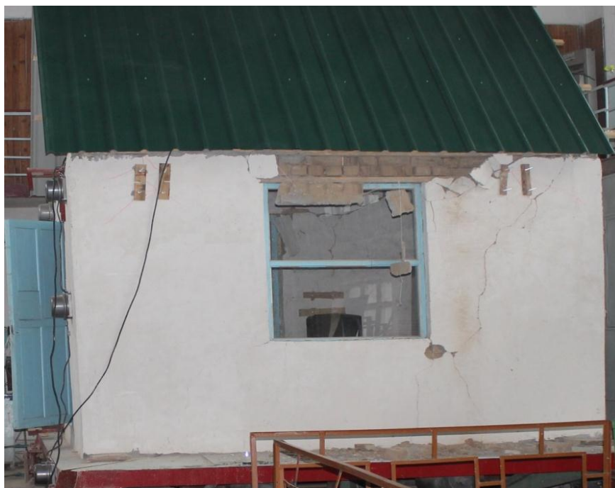
Рис. 4.Общий вид модели дома из кирпича-сырца после эксперимента
