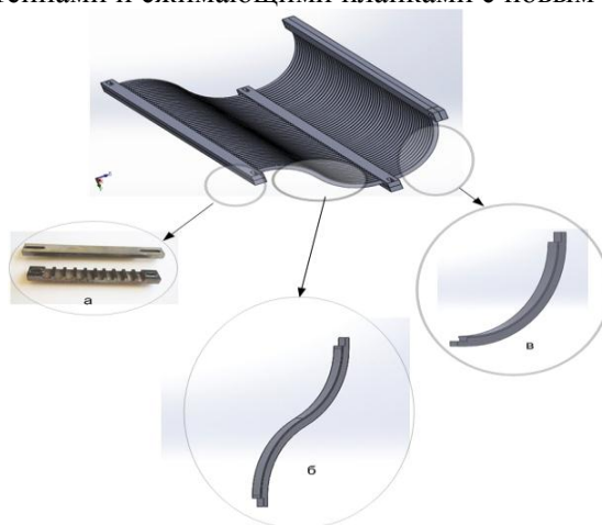
Рис.1. Новая смоделированная разборная экспериментальная колосниковая решетка: а – кронштейн с зажимной планкой; б – нижний колосник; в – верхний колосник
