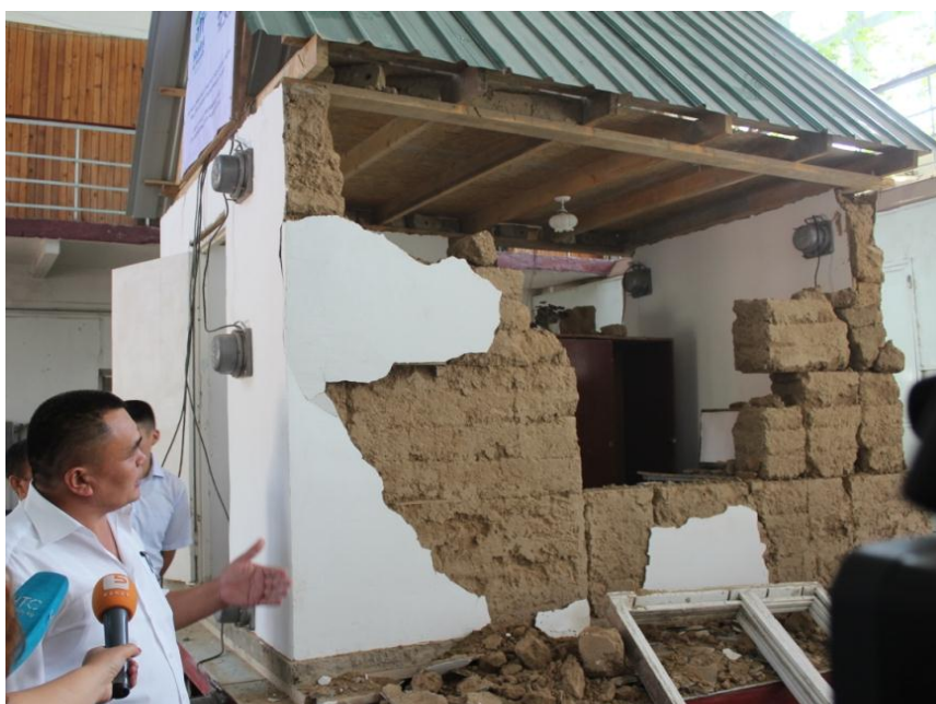
Рис. 3. Общий вид модели дома «сокмо» после эксперимента
