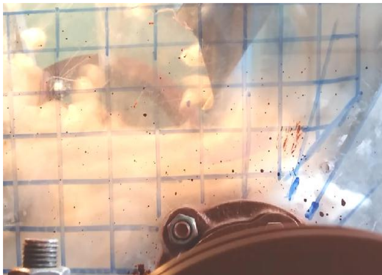
Рис.8. Траектория движения хлопка (диаметр – 145мм, частота вращения – 350 об/мин, производительность – 1200 кг/ч, угол падения хлопка на поверхность колка набрасывающего барабана \varphi_0=60^\circ )
